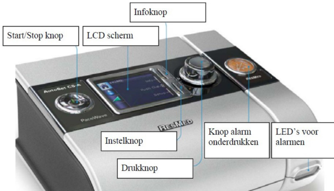
Afbeelding 3: Display met bedieningsknop
