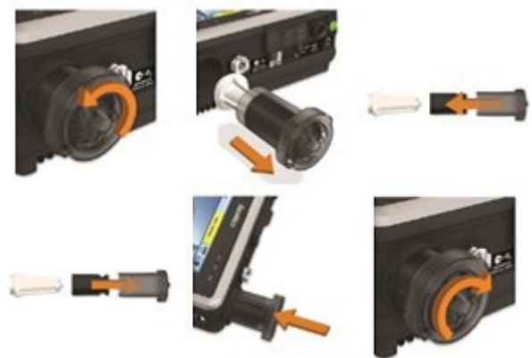
Afbeelding 5: Controle/vervanging luchtfilter
